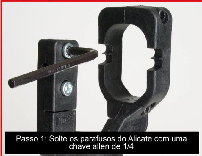
Passo 1: Solte os parafusos do Alicate com uma chave allen de 1/4
